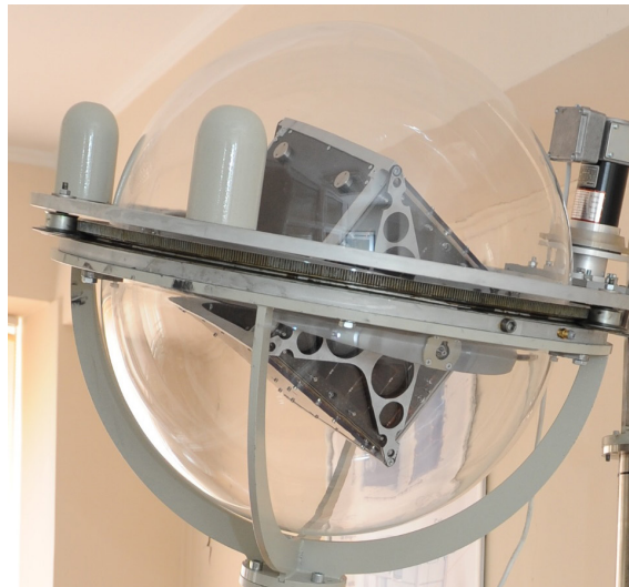
Foto 5. Microsatelitul montat în cuibul port-satelit vacuumat cu mișcare sferică, CNTS, UTM
