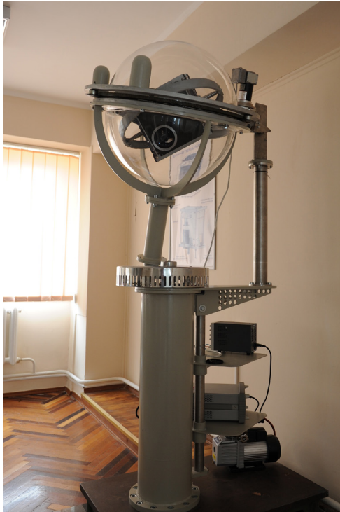
Foto 4. Simulatorul cu Microsatelitul montat în giroscopul extern, CNTS, UTM
